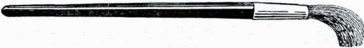
Fig. 2 - Pennello per decorazione alla turca. Può essere sostituito da qualsiasi altro a punta larga.
